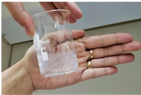
Figura 18 – Filme polimérico seco na parede de um béquer.
