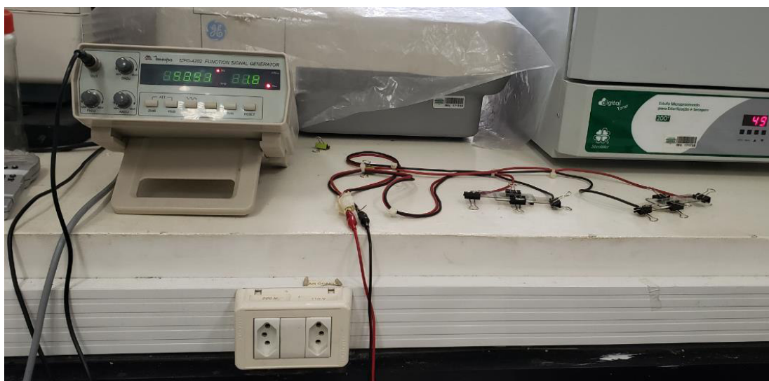
Figura 4 – Eletrodos revestidos por uma fina camada de copolímeros ligados ao gerador de campo elétrico.
